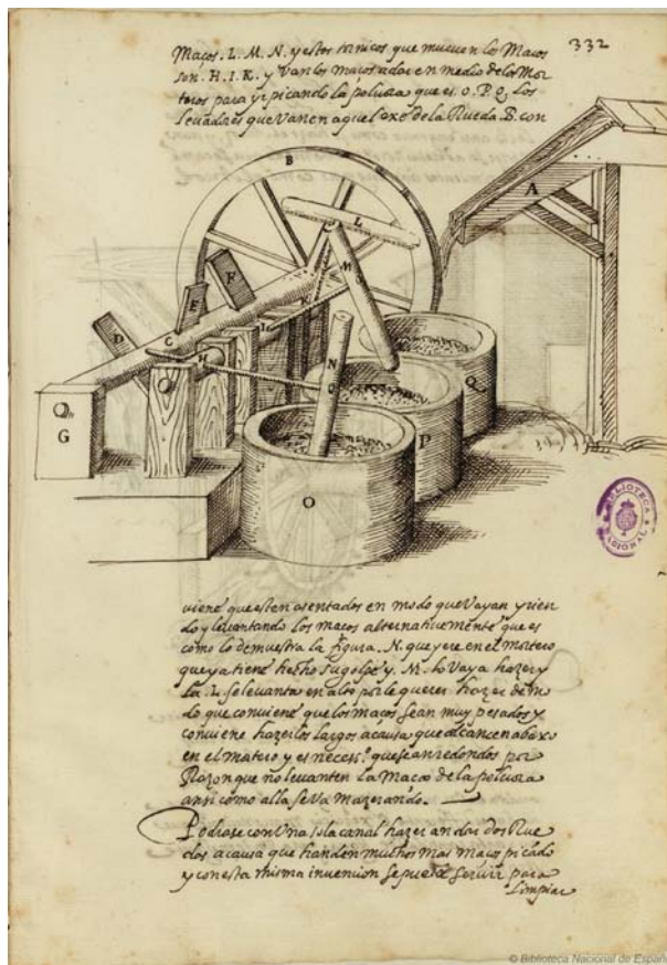
Figura 4. [Juanelo Turriano], ss. XVI-XVII: Los Veinte y un Libros de los Yngenios, Y Maquinas de luanelo . (Mss. T. III, fols. 332 y 320 respectivamente) Batán y molino flotante. Biblioteca Nacional de España, Madrid.
