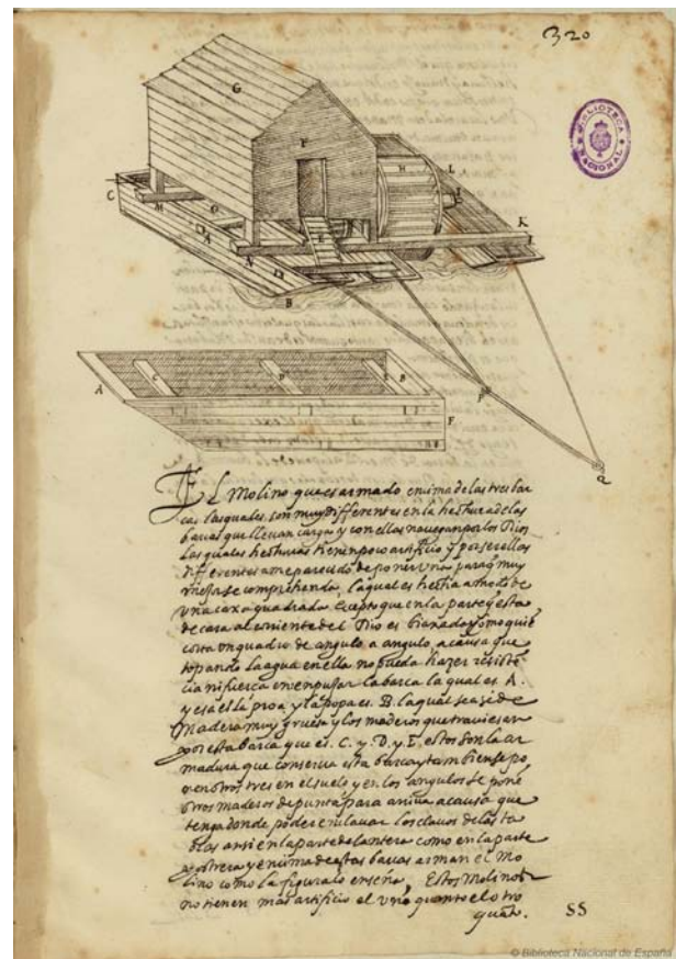
Figura 4. [Juanelo Turriano], ss. XVI-XVII: Los Veinte y un Libros de los Yngenios, Y Maquinas de luanelo . (Mss. T. III, fols. 332 y 320 respectivamente) Batán y molino flotante. Biblioteca Nacional de España, Madrid.
